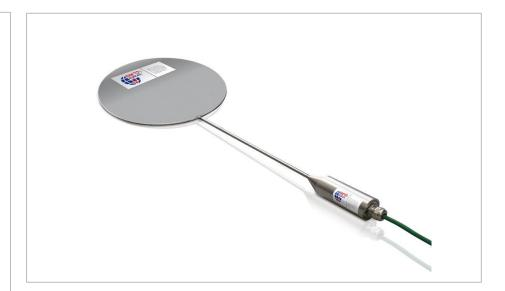
La cella di pressione per terreni viene utilizzata per monitorare la pressione totale tra la struttura e il terreno stesso.
