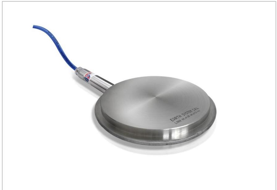
La cella di carico idraulica è uno strumento formato da due piastre di acciaio inox saldate lungo il loro perimetro e separate all'interno da una cavità saturata sotto vuoto con olio disaerato per garantire la massima rigidità.
