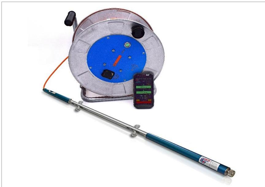
Il sistema di misura estensimetrico removibile bluetooth viene utilizzato per effettuare misure estensimetriche incrementali grazie all'utilizzo di tubazioni inclinometriche ed anelli magnetici.
